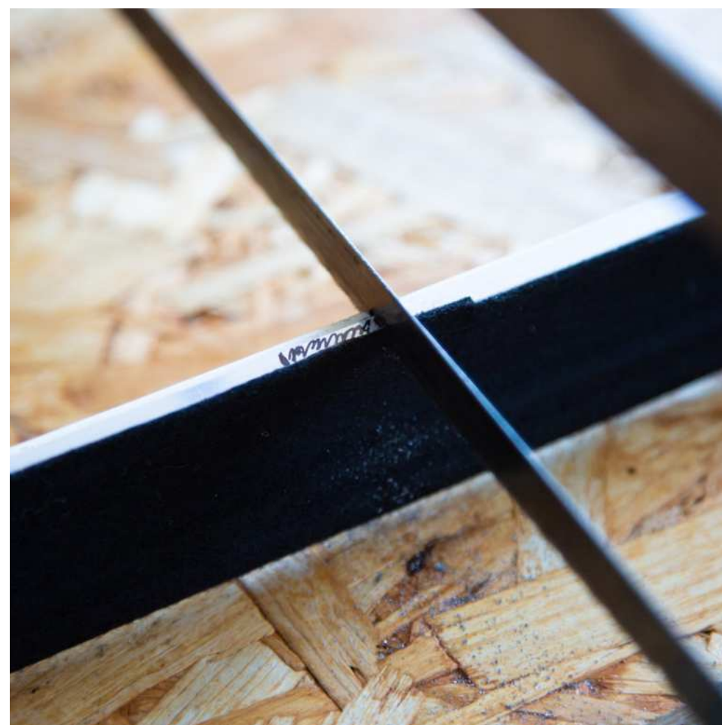
rys. 1.10: Przecięcie białego paska kleju w oznaczonym miejscu
