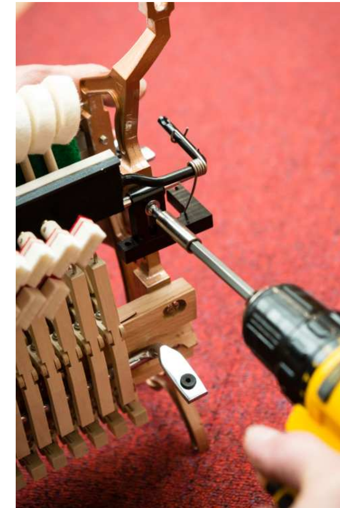
rys. 1.14: Mocowanie szyny wyciszającej
