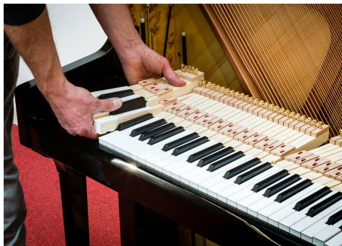
rys. 2.8: Demontaż klawiszy w kroku 1
