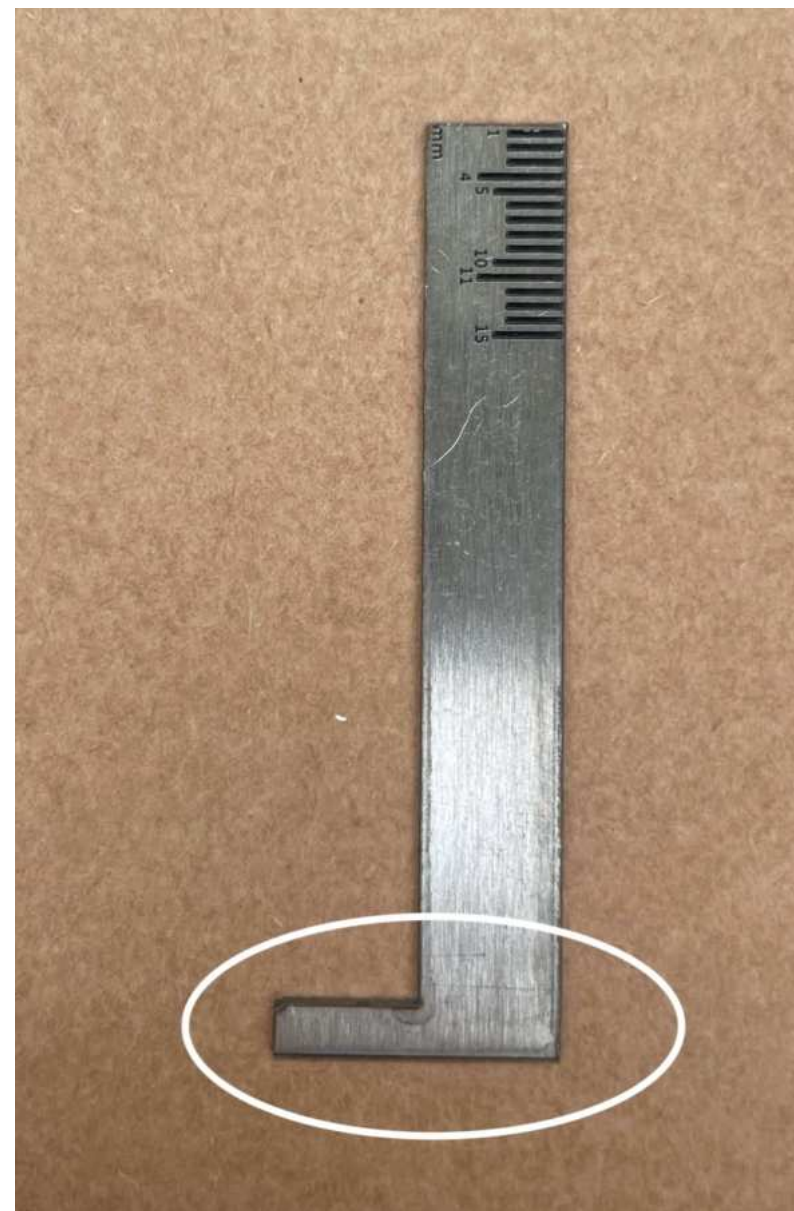
rys. 2.6: Narzędzie pomiarowe do odległości między płytą a klawiszem
