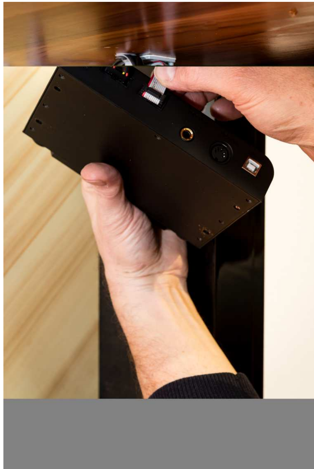
rys. 3.1: Podłączenie kabli komunikacyjnych klawiatury i pedału
