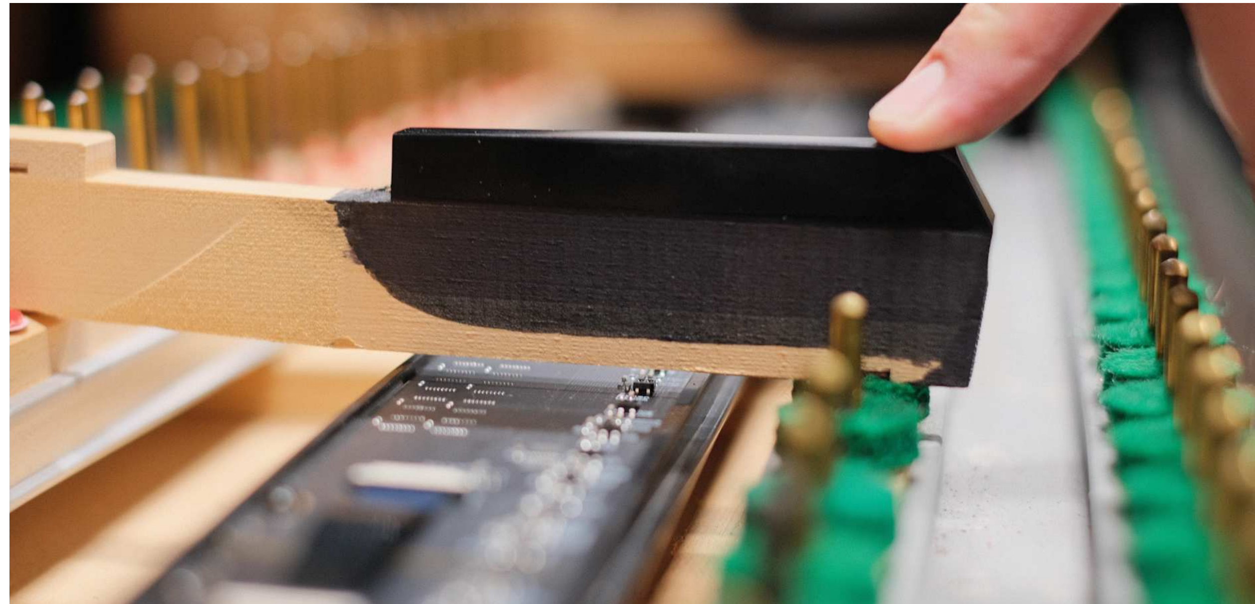
rys. 2.7: Pomiar odległości między płytą a klawiszem.
