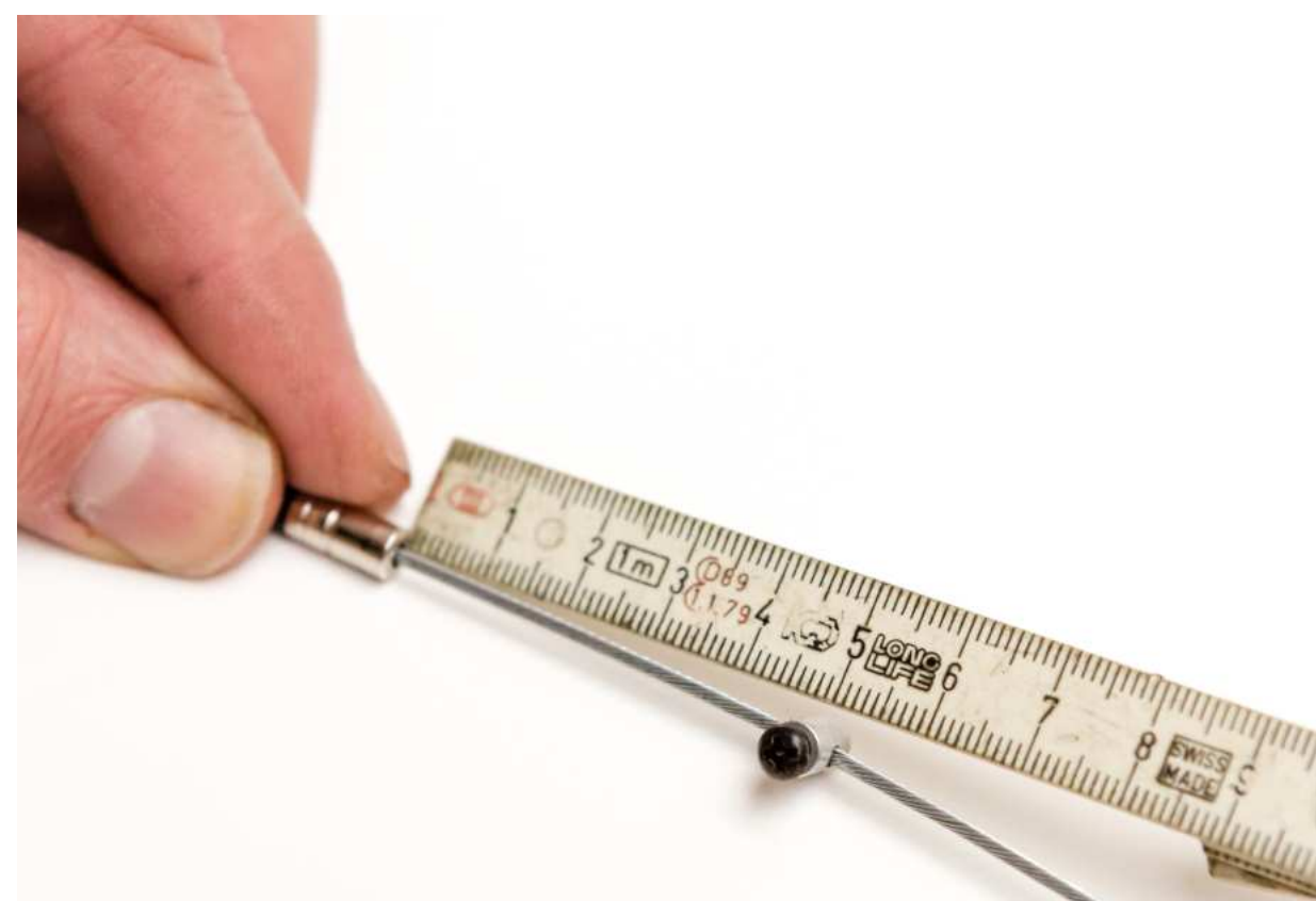
rys. 1.20: Odległość blokady zacze­pu
