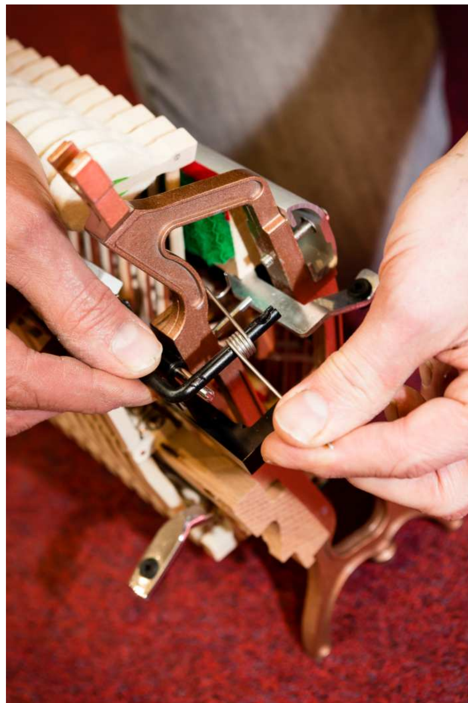
Abb. 1.17. Einbau der Feder
