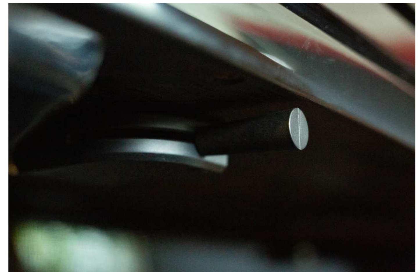
Abb. 1.25: Der Hebel steht parallel zur Stuhlbodenkante wenn das System ist eingeschaltet.
