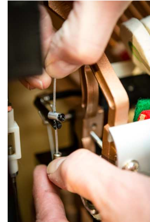
Abb. 1.23: Feineinstellung des Bowdenzuges
