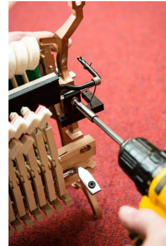
Abb. 1.14: Fixierung der Stoppleiste
