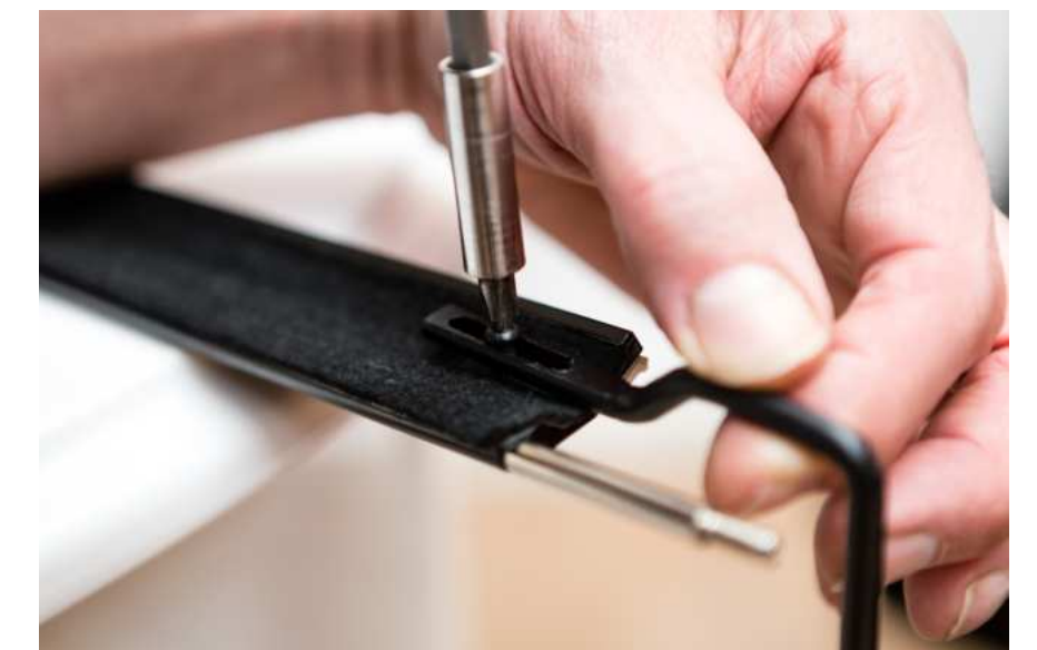
Abb. 1.4: Befestigung des Betätigungswinkels
