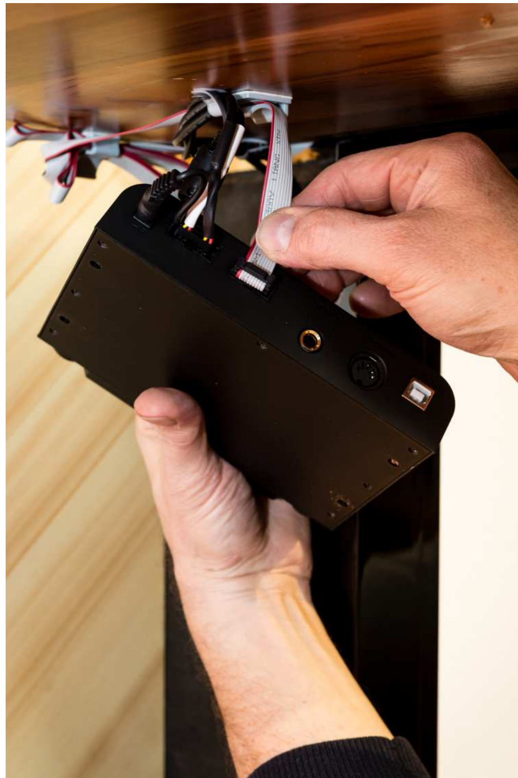
Abb. 3.1: Kabelanschlüsse für Tasten- und Pedalsensoren
