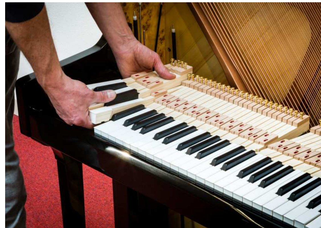
Abb. 2.8: Demontage der Tasten im Schritt 1
