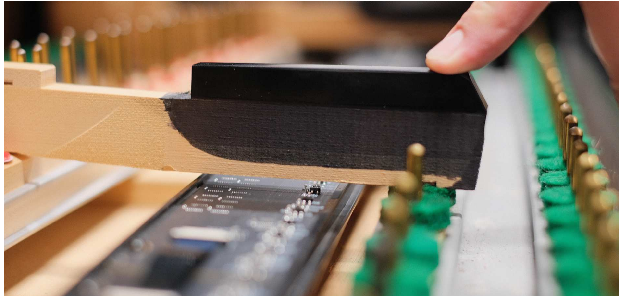
Abb. 2.7: Messung des Abstands zwischen der Platte und der Taste.
