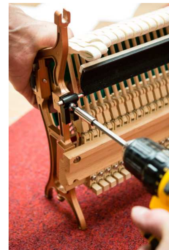
Abb. 1.16: Die Hämmer laufen frei über die Stoppleiste, im Diskant bleibt Platz für einen Stimmkeil.
