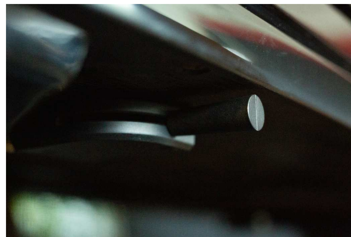
図 1.25: ミュートレバーを引くと、ピアノの前面と同じ高さになる。
