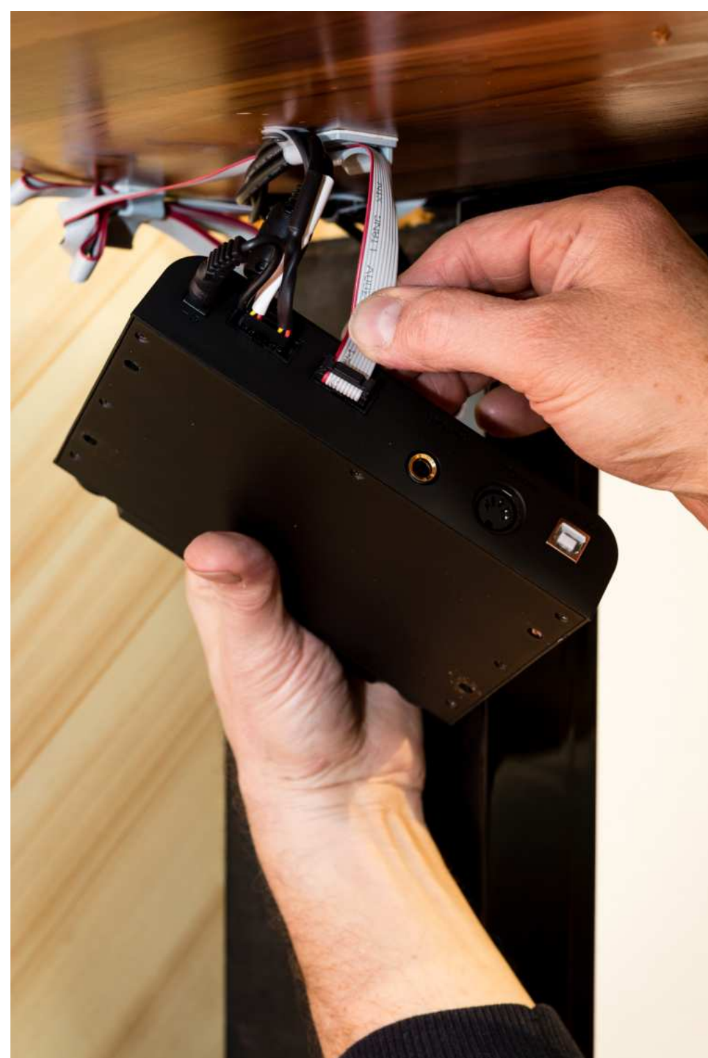
図3.1: キーボードとペダルの通信ケーブルの配線
