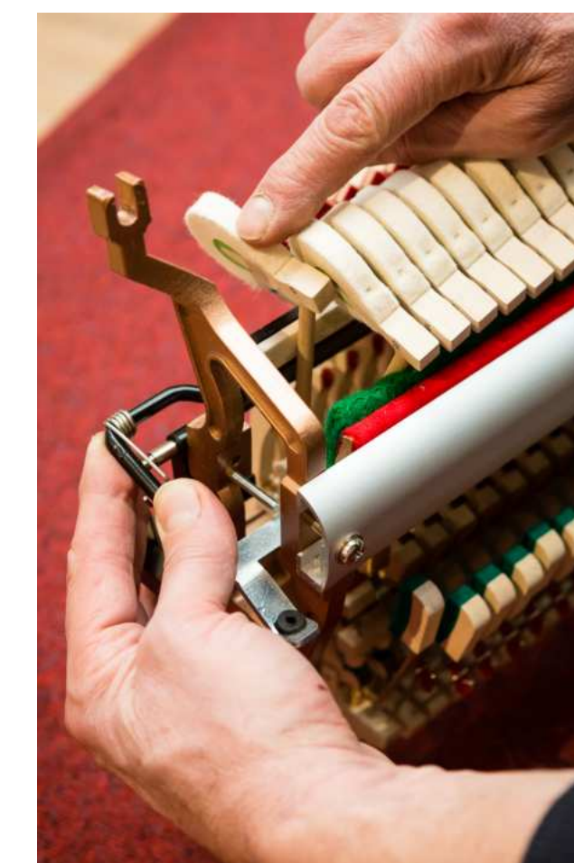
fig. 1.8: Confirmar que todos los mangos de macillos se puedan detener
