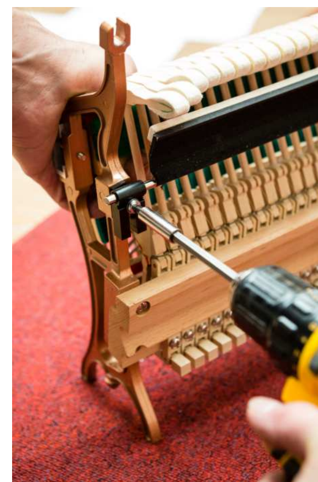
fig.1.16: Verificación de altura: Los macillos no pueden tocar la barra de silent.
