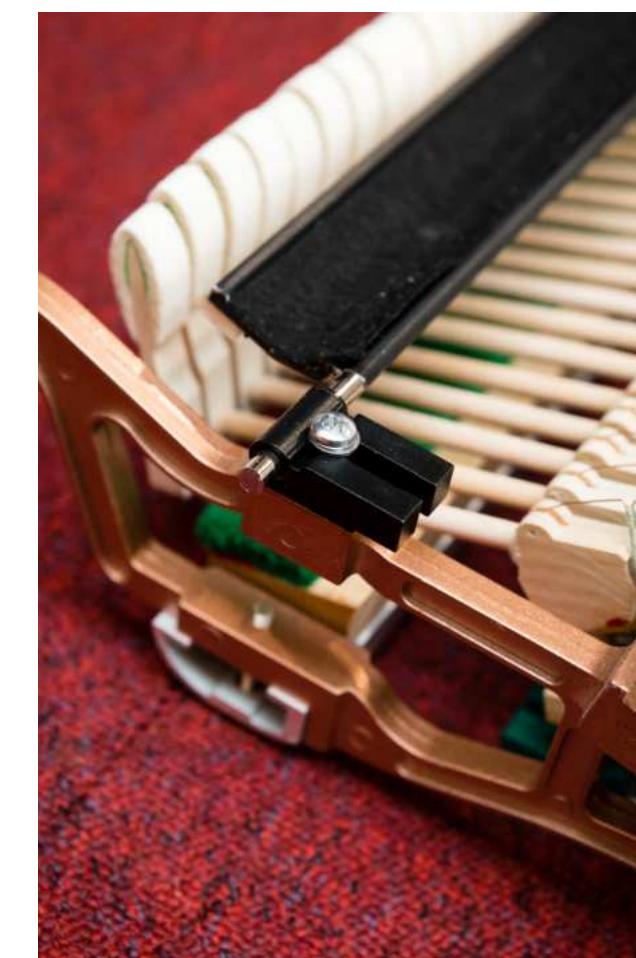
fig.1.15: Asegúrese de que todos los mangos de los macillos se puedan detener
