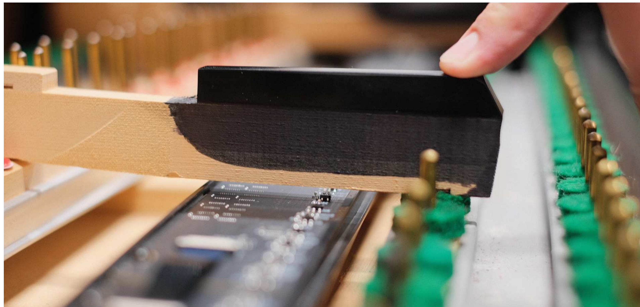
Fig. 2.7: Midiendo la distancia entre la placa y la tecla.
