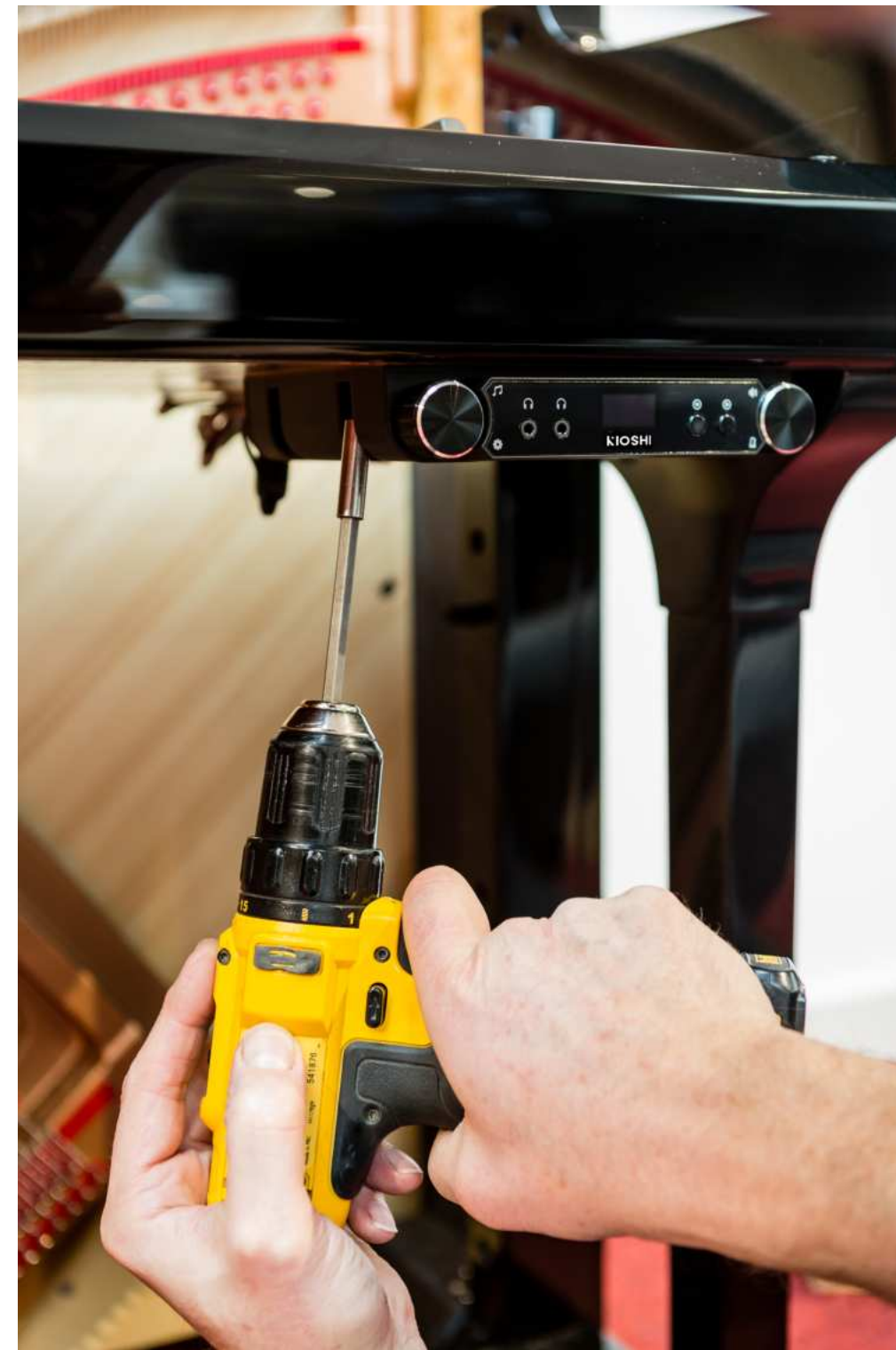
fig. 3.2: Medición de la posición para instalar la caja de control
