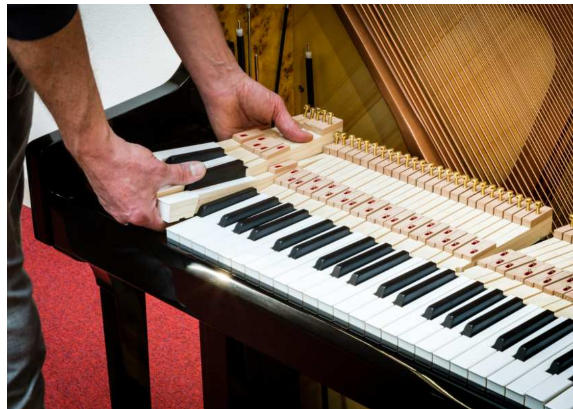
fig. 2.8: Desmontaje de teclas en el paso 1
