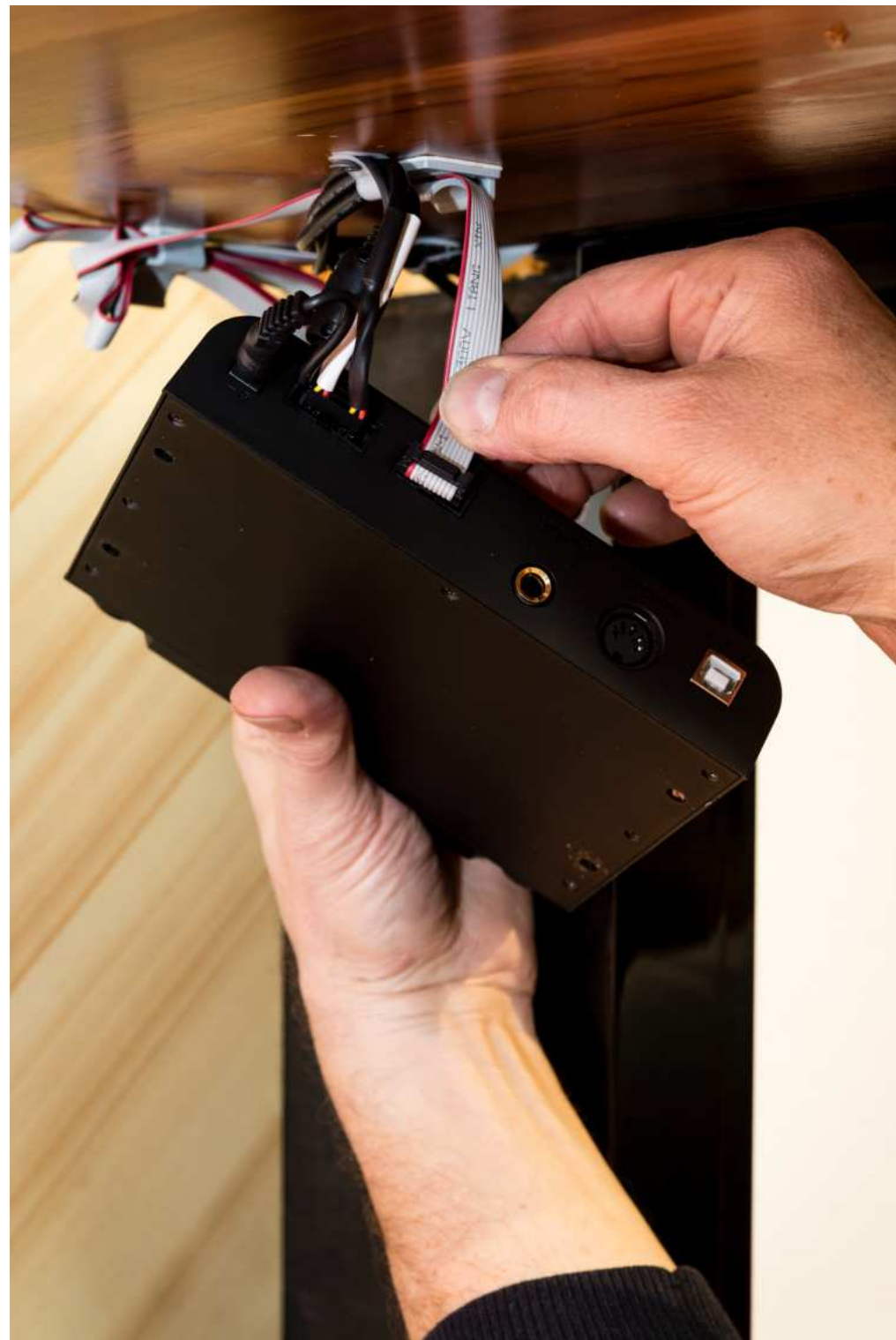
fig. 3.1: Cableado de cables de comunicación de teclado y pedal
