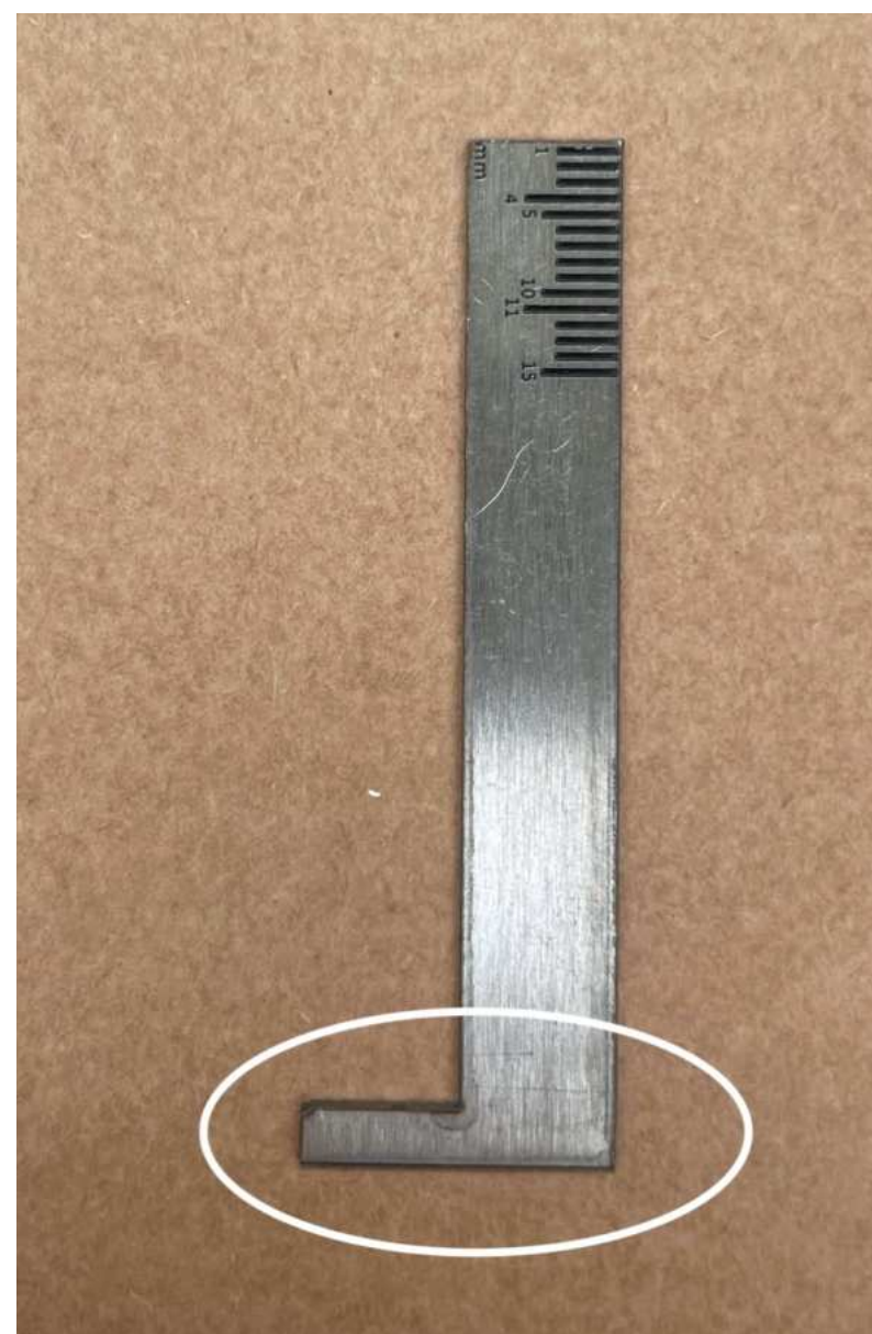
Fig. 2.6: Herramienta de medición para la distancia entre la placa y la tecla.
