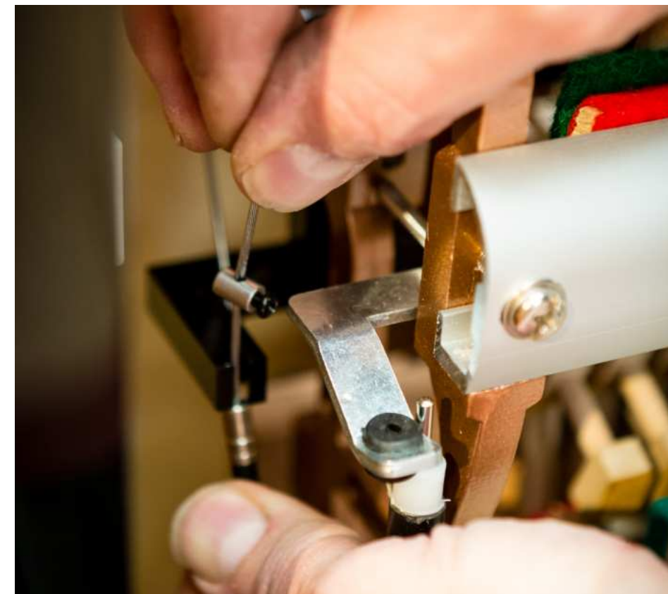
fig.1.21: Cubierta del cable en soporte en L
