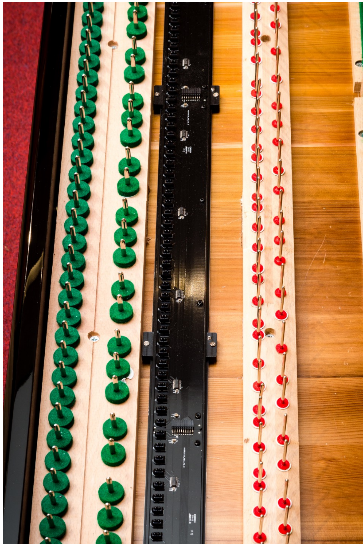
fig. 2.4: Verdeel de houders evenredig over de sensorrail.
