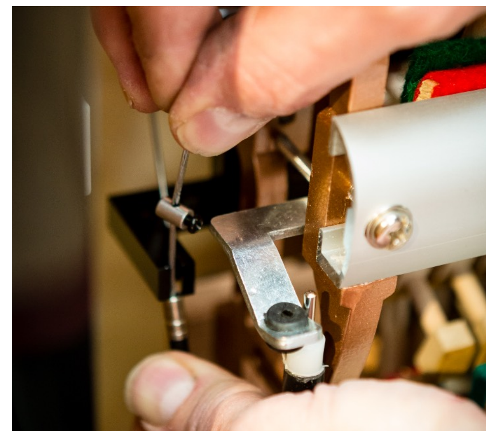
fig. 1.21: Kabelhuls in de L-type beugel.
