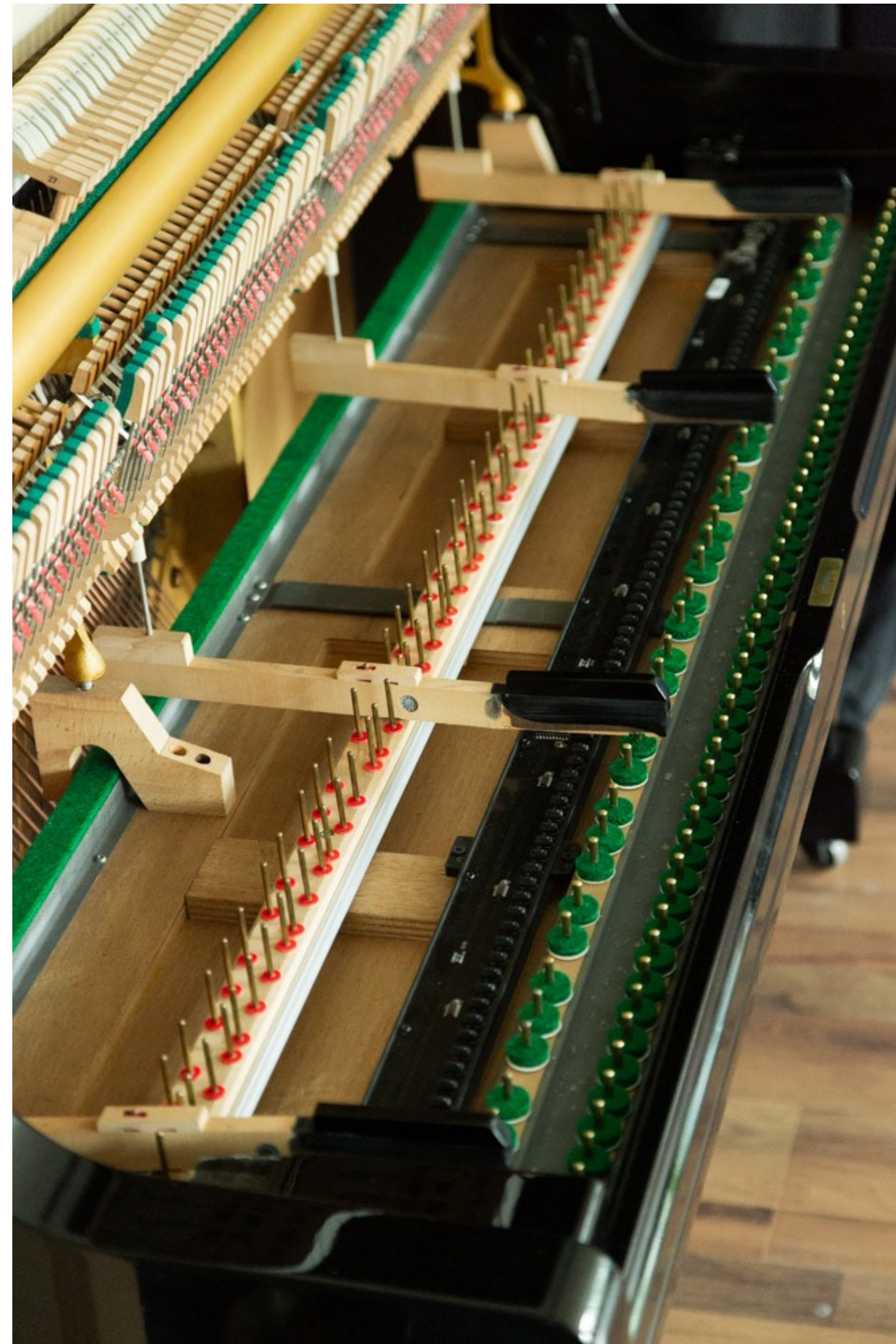
fig. 2.5: Afstelling van de sensorrail positie.
