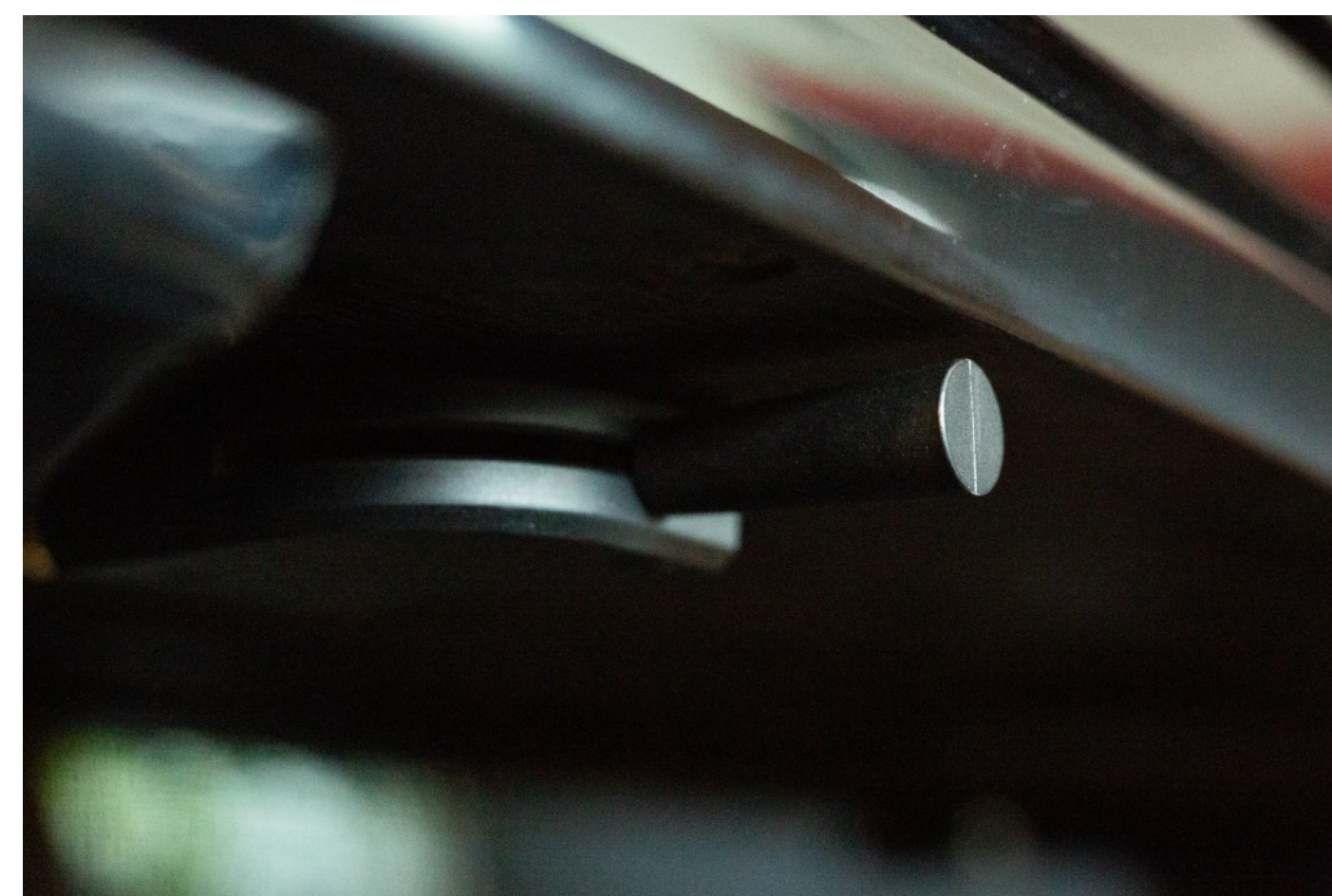
fig. 1.25: De demperhendel loopt in gespannen positie gelijk met de voorkant van de piano.
