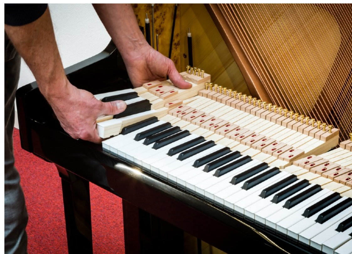
fig. 2.7: Het verwijderen van de toetsen (stap 1).
