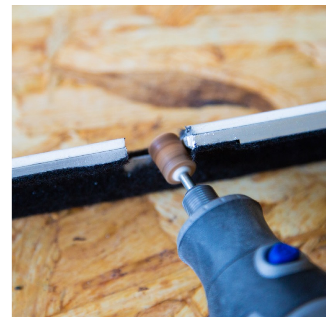
fig. 1.13: Vijl de scherpe randen af met een ijzervijl of multitool.
