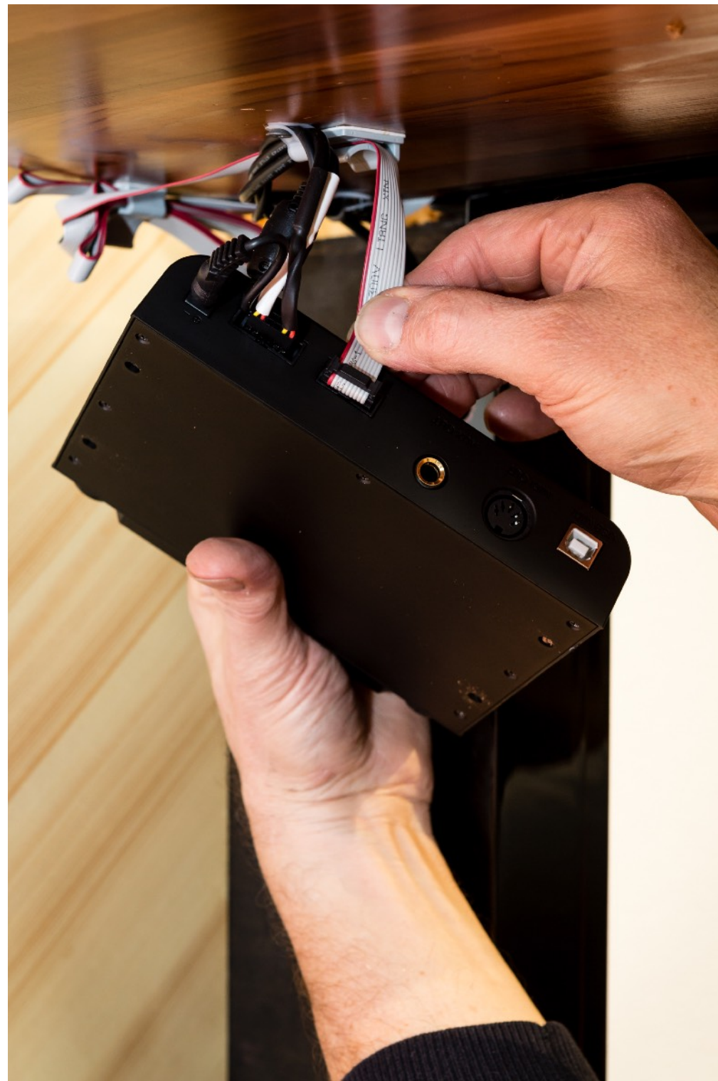
fig. 3.1: Aansluiten van de signaalkabels.
