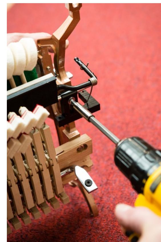
fig. 1.14: Montage van de demperrail.
