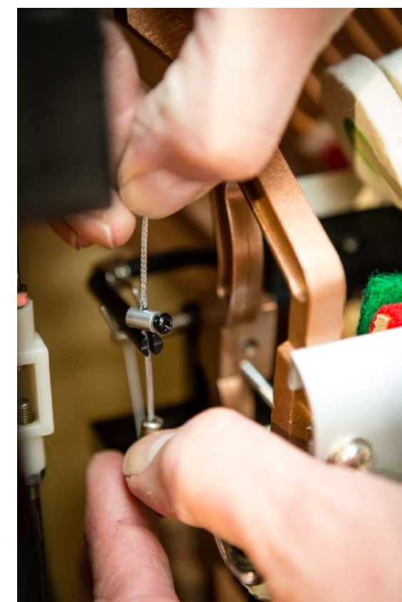
fig. 1.23: Fijnafstelling van de remkabel.
