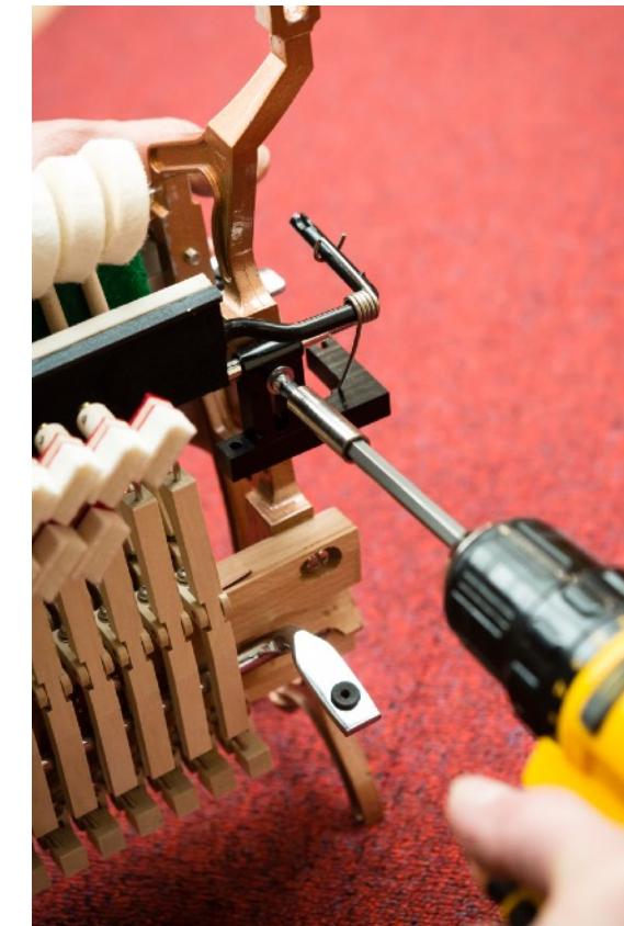
fig. 1.14: Montage de la barre de blocage
