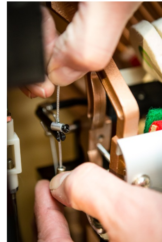
fig. 1.23 : Réglage fin du câble
