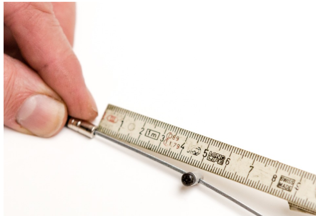
fig. 1.20: Distance de la bague serre-câble
