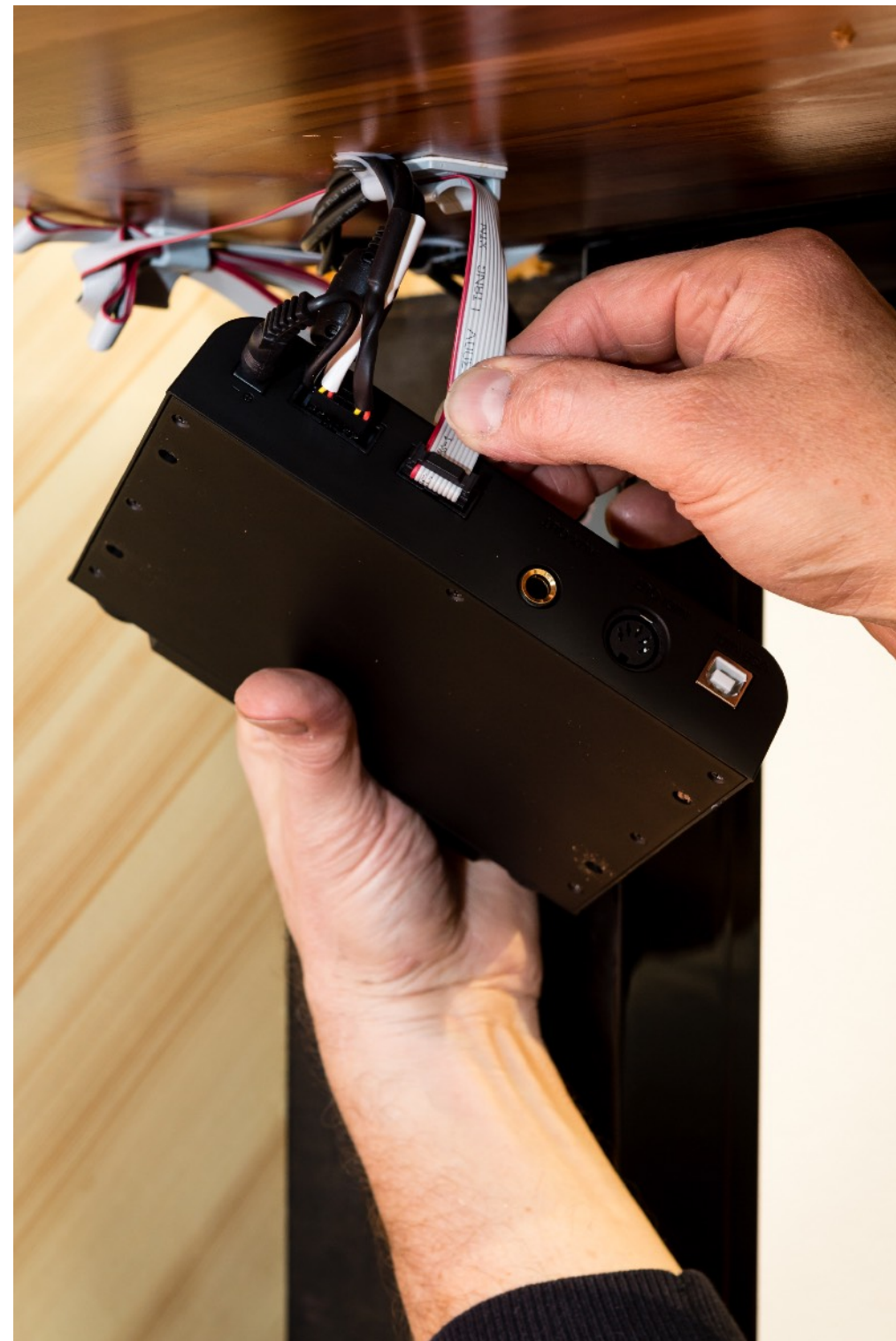
fig. 3.1 : Connexion des câbles du clavier et des pédales
