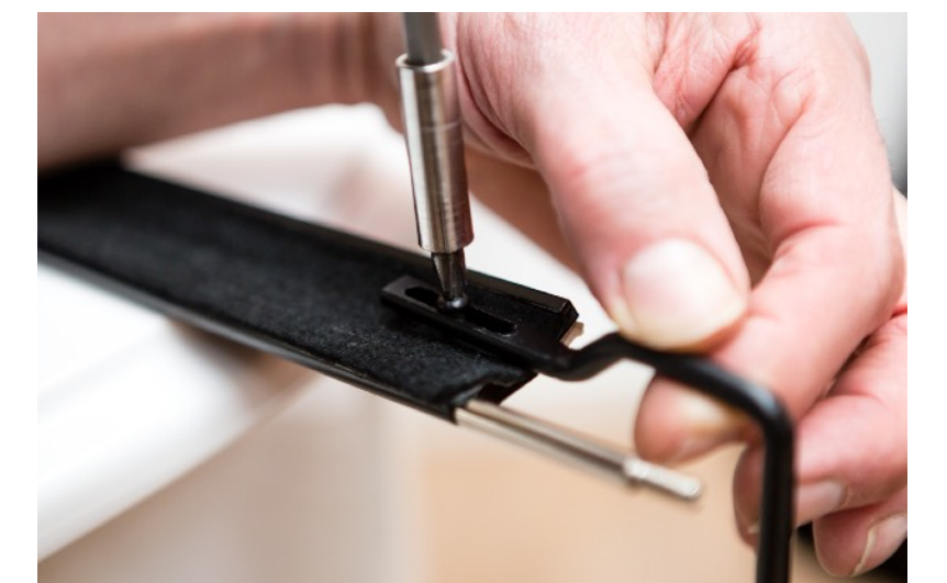
fig. 1.4 : Installation de l'équerre de commande
