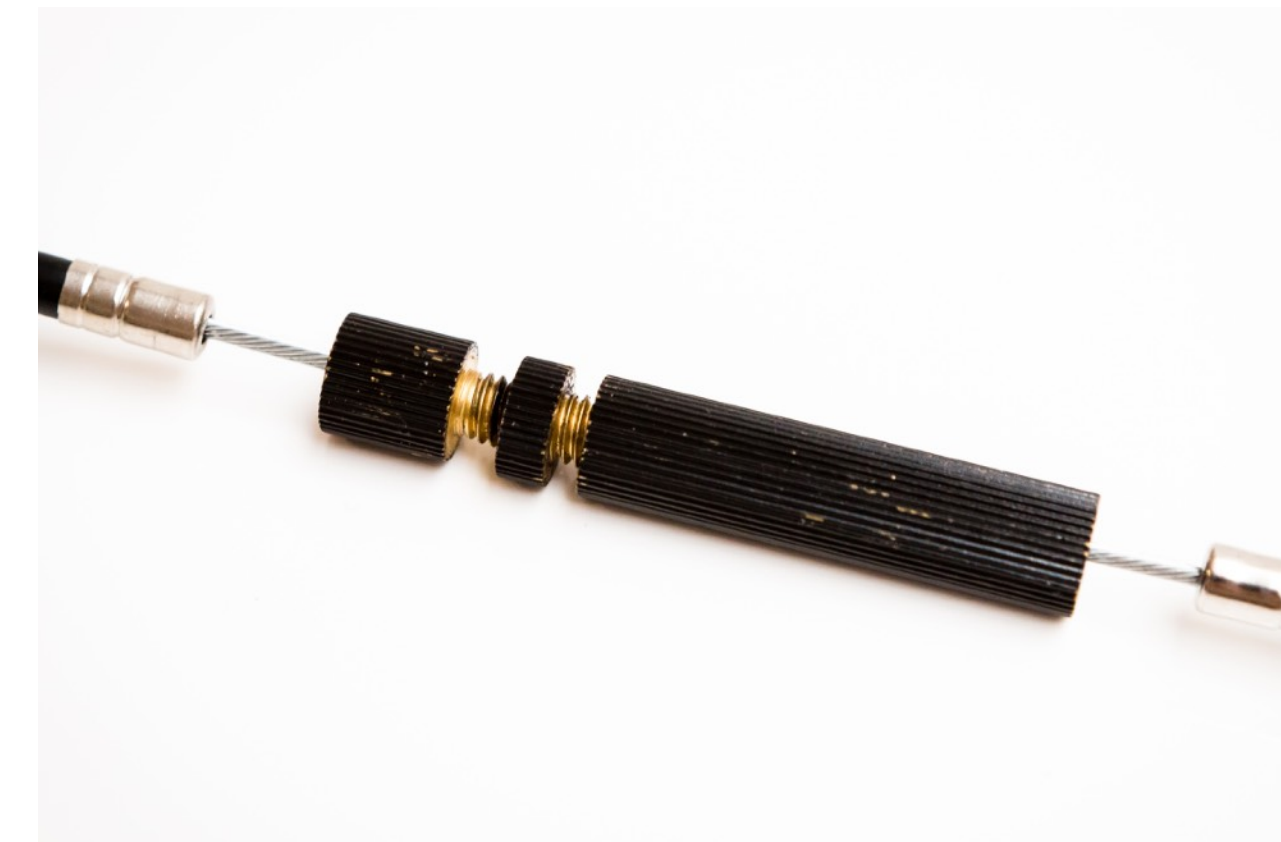
fig. 1.22: Régler la tension du câble
